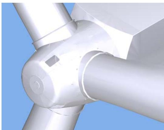
Eksemplet viser turbine og vinger på en vindmølle. Mesh tolerancen er sat til 0 og mesh resolution er lig 4000.
