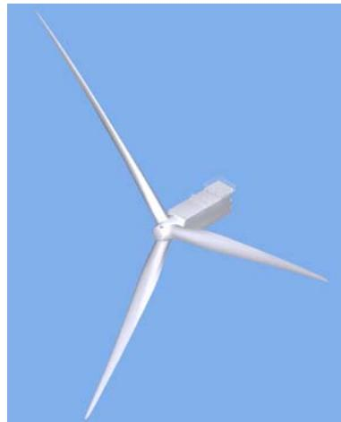
Med mesh tolerancen styrer man, hvor godt krumme og dobbelt-krumme elementer overføres til 3D PDF. Man styrer pilhøjden fra det tilnærmede rette element til det krumme element.
